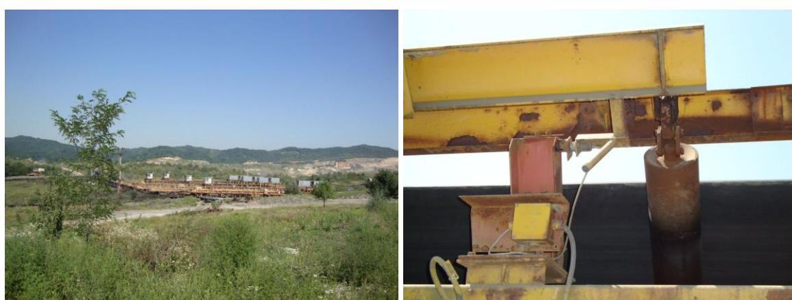
Obr. 3a,b: a - Záběr na otočný bod dálkové pasové dopravy (stacionární a magistrální dopravníky; b - zátěžové čidlo magistrálneho dopravníku MT 1-1.
